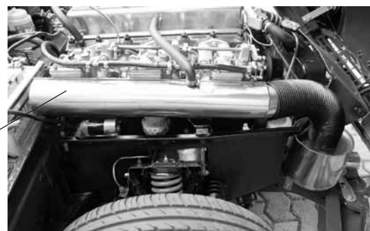
Luftfiltereinheit Edelstahl am Triumph GT6 / Ensemble filtrant en Inox pour le Triumph GT6
